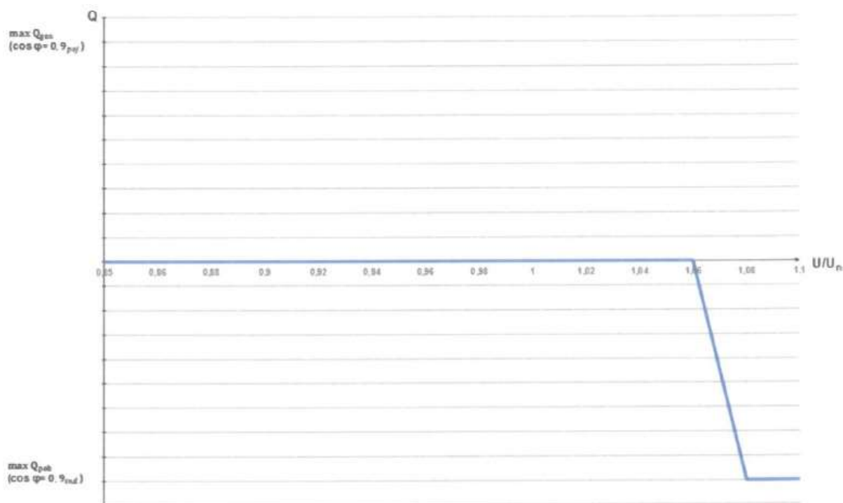
Rys.4. Charakterystyka sterowania mocą bierną w funkcji napięcia dla mikroinstalacji podłączonych jednofazowo, wymagana przez OSDn.
